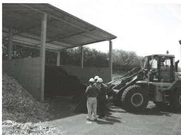
1. La pelle mécanique va prendre les palettes (à gauche) et déchets verts (à droite) pour les mélanger avec les boues qui viennent de la station d'épuration.
