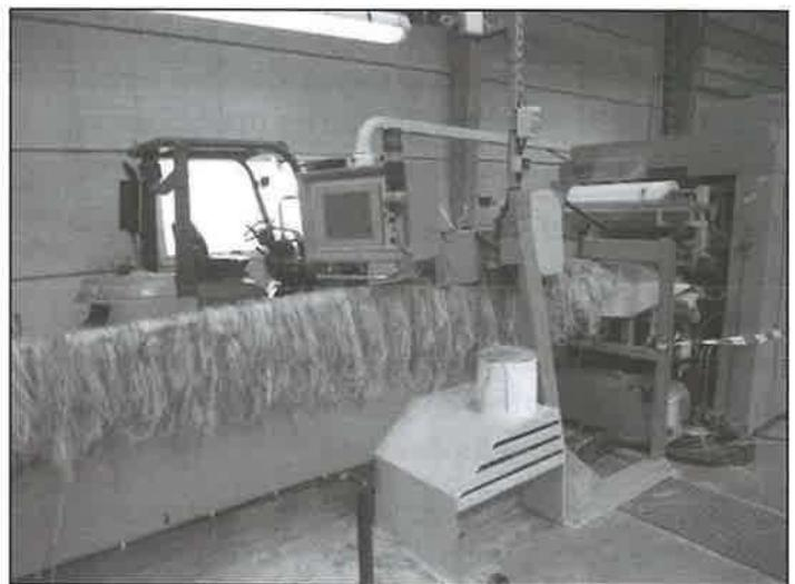
La ligne de nappes de fibres après le teillage après leur contrôle Cl. PB
